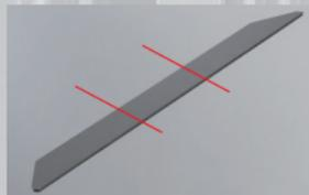
3. Das PUTZ-Aufsteckprofil des RAG<sup>2</sup>Kx. auf die gewünschte Länge zuschneiden. Durch das Zuschneiden ergeben sich ein linkes und ein rechtes Teil, je nach benötigtem Längenmaß. Bei Einzelverwendung wird eine Länge von bis zu 600 mm erreicht.
