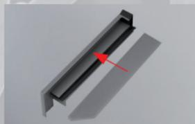
5. Das zugeschnittene PUTZ-Aufsteckprofil x.28 mm, x.34 mm oder x.48 mm auf das RAG<sup>2</sup>K Gleitstück aufstecken.
