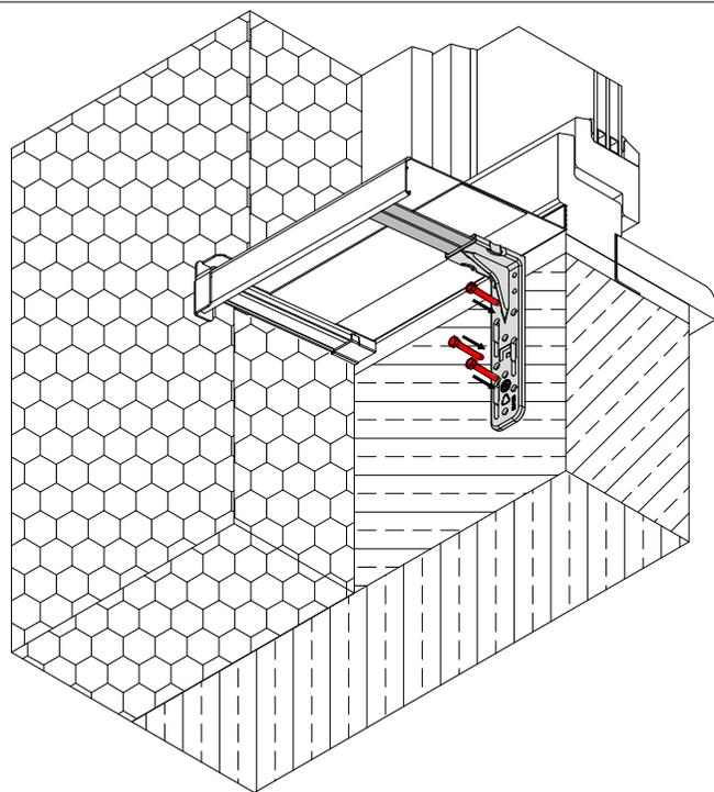
Halter RV-KSI 20 - 40 cm vom Fensterbankende mit geeigneten Schrauben abhängig vom Untergrund befestigen. (Halter dient ausschließlich als Niederhalter und nimmt keine Belastung von oben auf)
