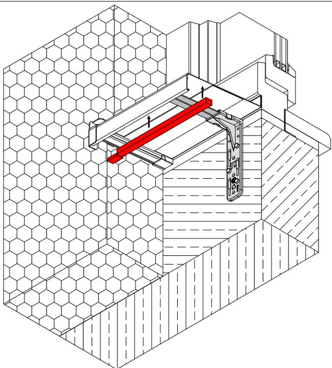
Vorkomprimiertes Dichtband auf Unterseite Fensterbank aufbringen.
