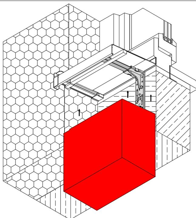
Passend zugeschnittene WDVS-Teile unter der Fensterbank montieren.
